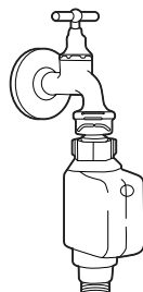
ống cấp nước an toàn
